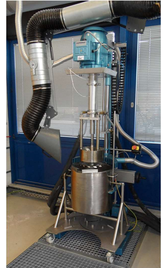
Dispermat zur Einarbeitung von Feststoffen in Dispersionen
