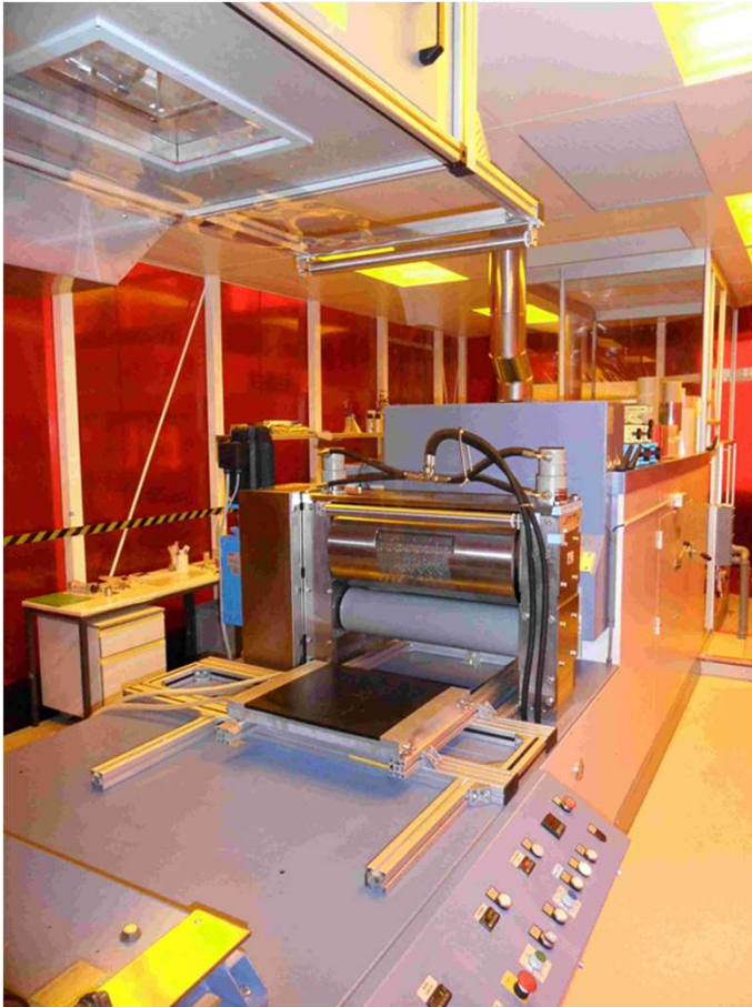
Nassbeschichtungsanlage mit 0,6m Arbeitsbreite inklusive Prägungseinheit
