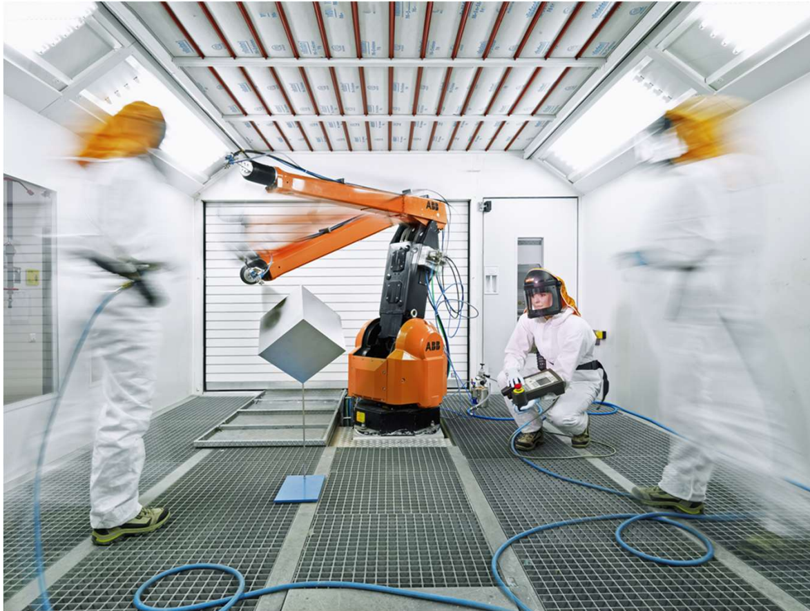
Lackierkabine mit Roboter für Sprühbeschichtung mit Drehteller für grosse und schwere Substrate
