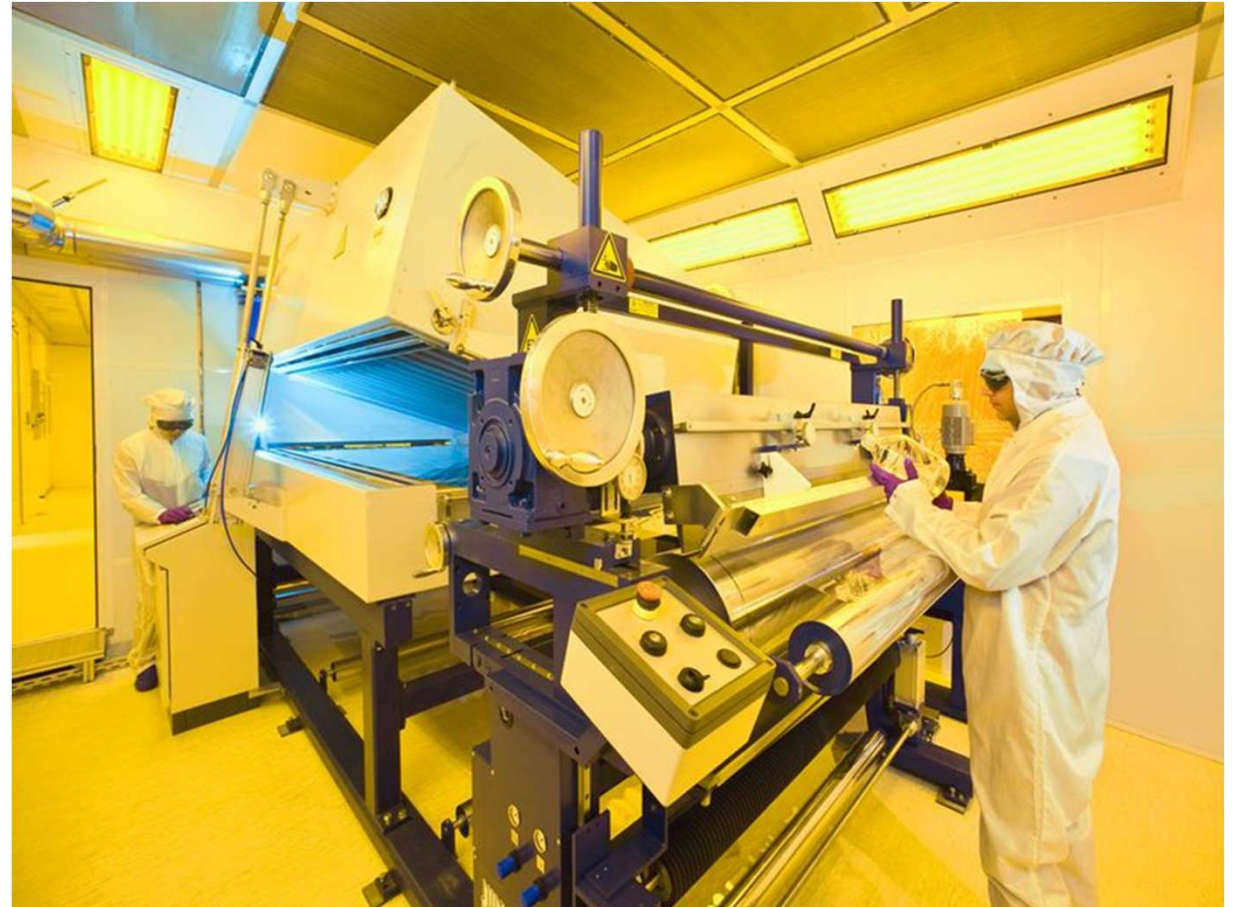
Nassbeschichtungsanlage mit 1,6m Arbeitsbreite in UV-geschütztem Reinraum
